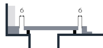
Tværsnit af afløbsarmatur med ramme/ med Panel i børstet stål.
