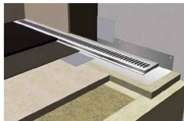
unidrain® med ClassicLine ramme/rist og Montagesæt 22 mm | væg
