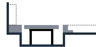
Tværsnit af afløbsarmatur med ramme / Panel i børstet stål.
